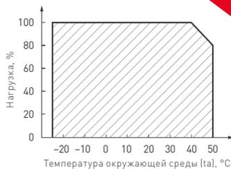
Рисунок 6. Максимальная допустимая нагрузка, % от мощности источника
