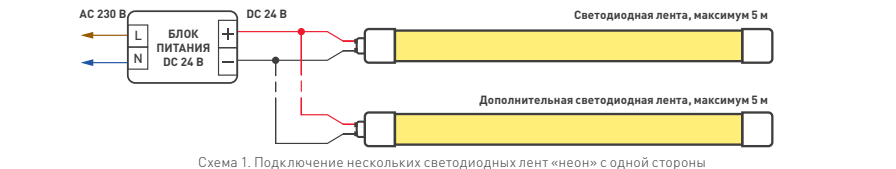
Схема 1. Подключение нескольких светодиодных лент «неон» с одной стороны
