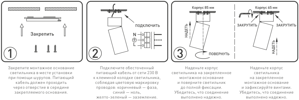
Рис. 3. Установка светильника
